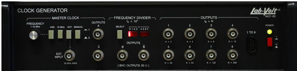
FIGURE B.4 – Générateur d'horloge *LAB – VOLT* 9421
