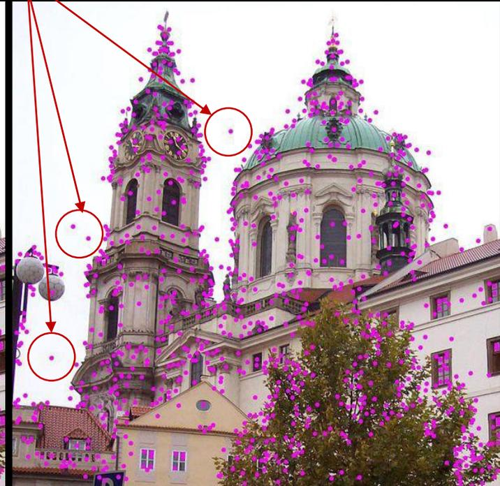
Pixels d'intérêt après l'élimination des pixels à faible contraste et des pixels d'arête
